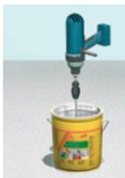
Gemischtes Material in ein sauberes Gefäss umfüllen (umtopfen) und erneut kurz durchmischen. Bei normal saugender Oberfläche wird Sikafloor®-156 mittels Rolle gleichmässig aufgetragen, bis die Fläche gesättigt ist. Material leicht filmbildend auftragen.
