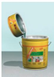
Die Komponenten A und B von Sikafloor®-156 werden vor der Verarbeitung zusammen gekippt und mit einem elektrischen Rührgerät (300–400 U/Min.) intensiv gemischt. Die Mischdauer beträgt mindestens 3 Minuten und ist erst beendet, wenn eine homogene Mischung entstanden ist.
